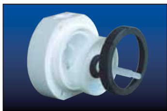
ハードシール (PAT.) ダイヤフラムは外周リングでアウトチャンバーに直接取付けられ一体化(締結)されているため、仮にアウトチャンバーが熱変形してもシール部からの液漏れはありません
